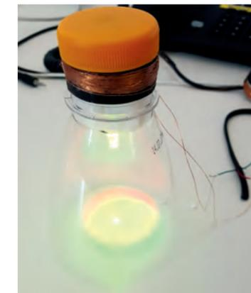
Links: Wie ein herkömmlicher Lautsprecher wandelt der Selbstbau das Eingangssignal in mechanische Schwingungen um; diese sind dann als Schall wahrnehmbar
